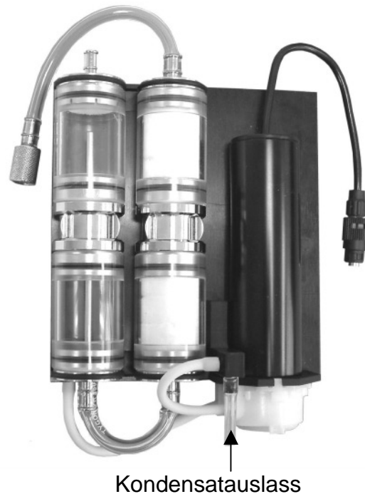
vollständige Gasaufbereitung mit Kondensatpumpe
